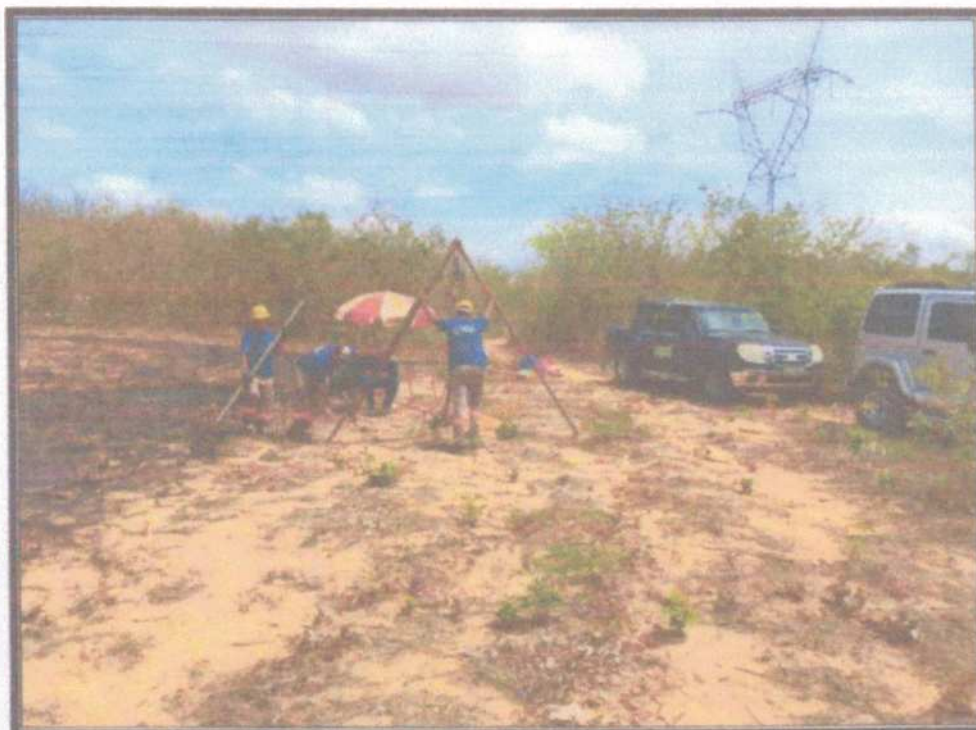
FOTO 1 – VISÃO PARCIAL DA ÁREA ONDE FORAM FEITAS AS SONDAGENS(SPT) NA JAZIDA EXISTENTE DENTRO DO TERRENO DA UVA, ACARAÚ-CEARÁ
