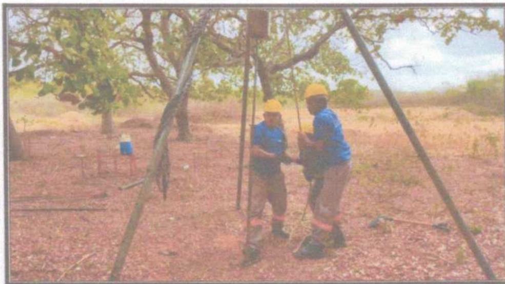
FOTO 2 – EQUIPE EXECUTANDO UMA SONDAAGEM SPT NA JAZIDA DE EMPRÉSTIMO DE SANTA FÉ, EM ACARAÚ, CEARÁ.
