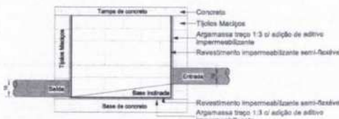
Corte lateral - Caixa de Inspeção 1 : 10
